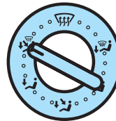
Control de distribución de aire
