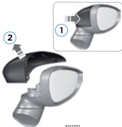
1. Presione el lateral de la cubierta para soltar los clips.
