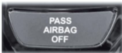
El sistema sensor del acompañante usa un indicador "PASS AIRBAG OFF" que se ilumina y permanece encendido para recordarle que el airbag frontal del pasajero delantero está desactivado. La luz indicadora se ubica en el área central del tablero de instrumentos.
