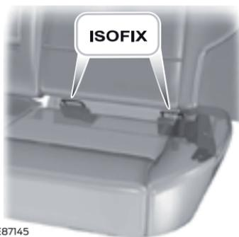
Empuje el asiento del niño para atrás firmemente para fijar los puntos de anclaje inferiores de ISOFIX.
