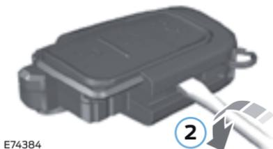
2. Gire el destornillador en la posición que se muestra para separar las dos mitades del control remoto.
