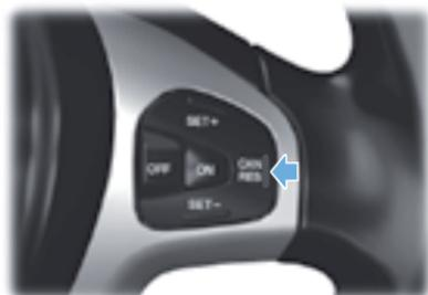
El indicador de control de velocidad crucero se activará y el sistema intentará reanudar la velocidad que fijó previamente.
