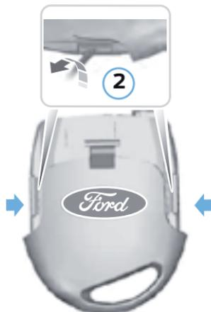
2. Libere las abrazaderas de retención con un el destornillador y separe las dos mitades del control remoto.
