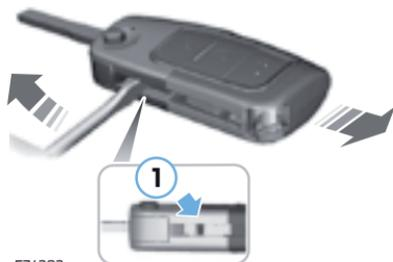
1. Inserte un destornillador tanto como sea posible en la ranura del costado del control remoto, empujelo hacia la hoja de la llave y retire la misma.
