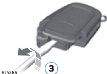
3. Gire el destornillador en la posición que se muestra para terminar de separar las dos mitades del control remoto.
