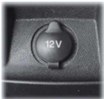
**Nota:** Si utiliza el tomacorriente cuando el motor no está funcionando, se puede descargar la batería.
